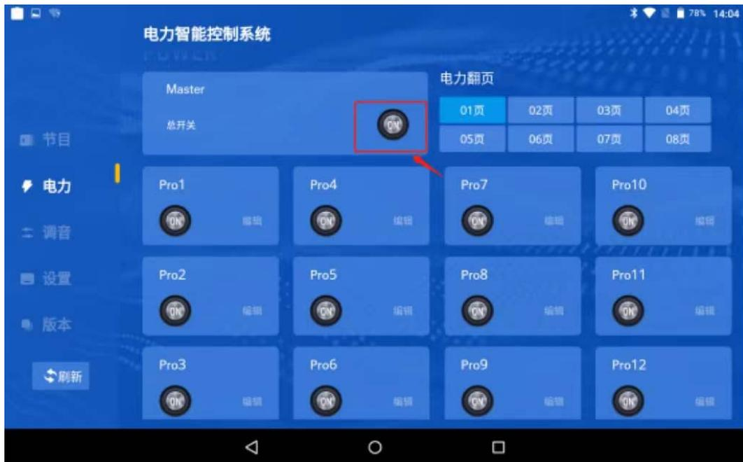
3.2 电力界面 1-8 页，每一页有 12 个独立控制开关可以单独控制智能电柜每一路电力的通断电；OFF 绿色状态表示电力关闭状态，ON 灰色按钮状态表示电力开启通电状态；
