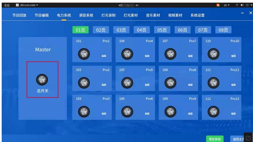
电力模块 1-8 页，每一页有 12 个独立控制开关可以单独控制智能电柜每一路电力的通断电；OFF 绿色状态表示电力开启通电状态，ON 灰色按钮状态表示电力关闭状态；
