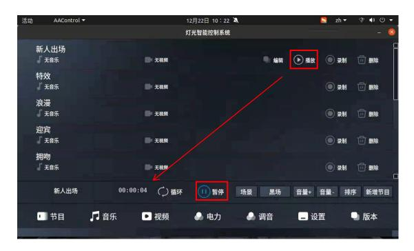
9.2 循环播放:点击播放区域的循环按钮,开启或关闭循环播放。图标蓝色表示开启状态,白色为关闭状态。
