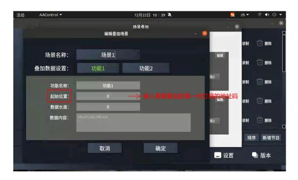
13.4.3 数据长度:输入需要叠加的灯具,第一台灯具到最后一台灯具的通道数总和 (如:六台8通道的帕灯,数据长度输入:48)
