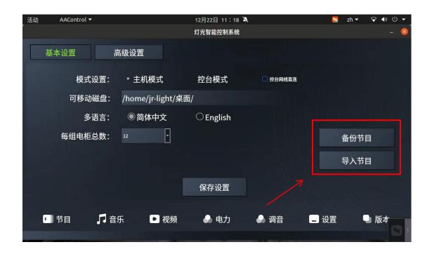
14.3.1 此界面可设置模式选择: 主机模式/控台模式/控台网线直连,设置好需要保存设置 (通过网络扩展器连接灯具设备的需把控台网络直连选择上, 用信号线无需选择控台网络直连)
