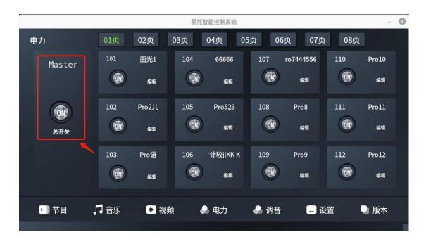
15.2.电力模块 1-8 页,每一页有 12 个独立控制开关可以单独控制智能电柜每一路电力的通断电; OFF 绿色状态表示电力关闭状态, ON 灰色按钮状态表示电力开启通电状态;
