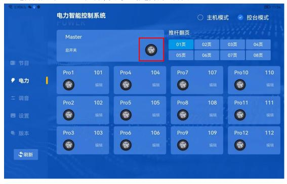
5.2 电力界面 1-8 页,每一页有 12 个独立控制开关可以单独控制智能电柜每一路电力的通断电; OFF 绿色状态表示电力关闭状态, ON 灰色按钮状态表示电力开启通电状态; 可在主机上编辑名称自定义命名; 同步到移动端; 使用操作更直观简便。...
